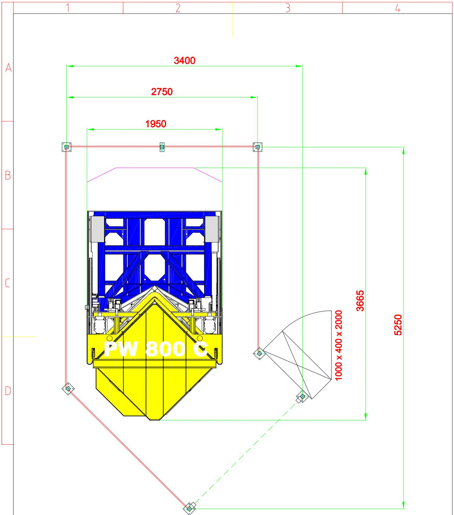
Die Abmessungen des Schutzzauns und die Ausrichtung der Maschine können im Auftragsfall an die Betriebsumgebung angepasst werden.
