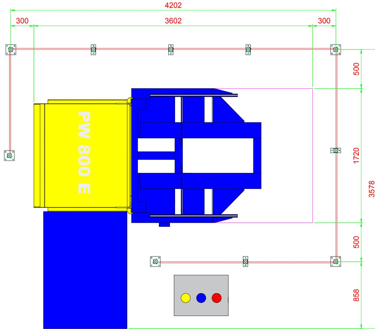
Die Abmessungen des Schutzzauns können im Auftragsfall an die Betriebsumgebung angepasst werden.
