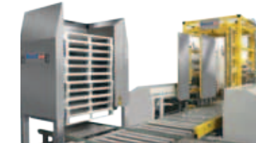
Palettenwechsler, auch einsetzbar unter Reinraumbedingungen
